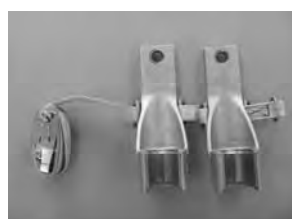
080107 異形管解体用 シリンダー治具
