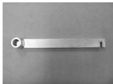
080108 解体矢打込み工具
