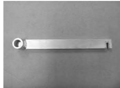
080108 解体矢打込み工具
